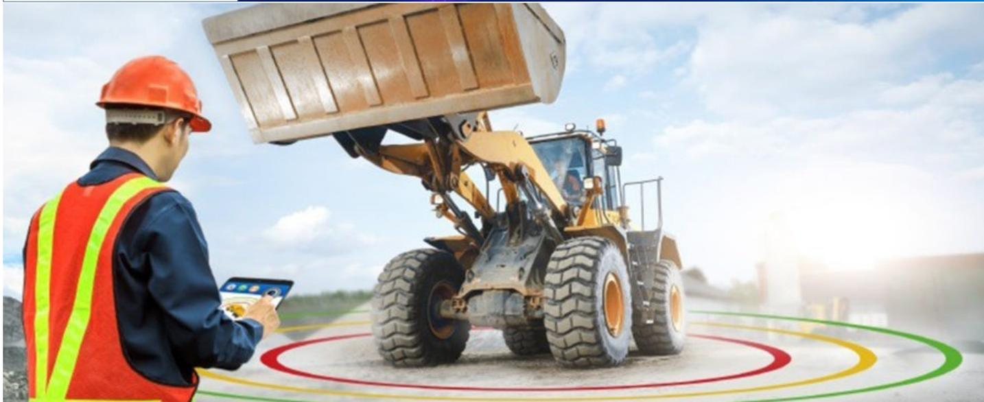
Il sistema è modulare e completamente configurabile, sia da remoto che per mezzo di una app. Si possono installare telecamere frontali e laterali.
